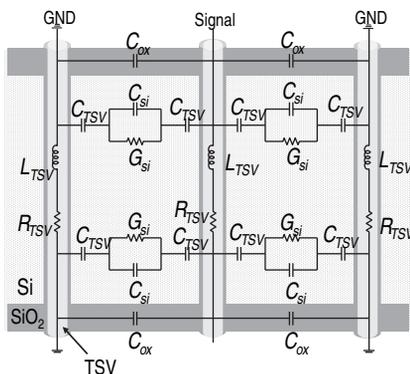
Fig. 3. An  $RLC$  model of a TSV.<sup>10</sup>
